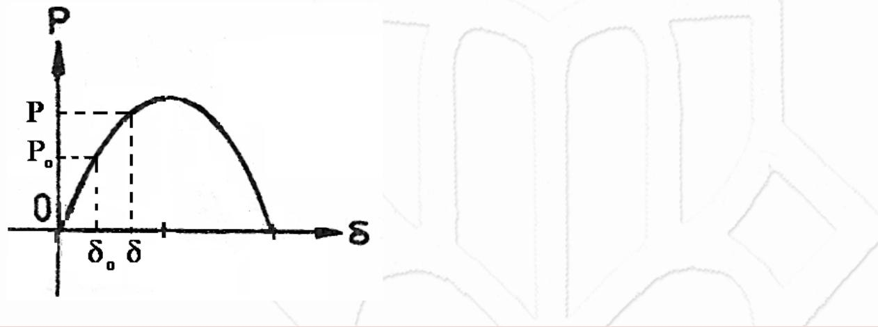
■ جواب: ملاحظه شده است که در تغییر پله‌ای بار، ماشین حول نقطه کار نهایی نوسان کرده تا در نهایت بواسیله عوامل میرا کننده نظیر اصطکاک و دمپرها در نقطه کار نهایی، ثابت شود. در شرایط خاصی این نوسانات ممکن است باعث ناپایداری شود که در بحث پایداری دینامیکی به آن پرداخته می‌شود.
