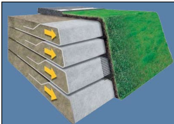
شکل ۲: استفاده از ژئوتکستایل در دیوار حایل
